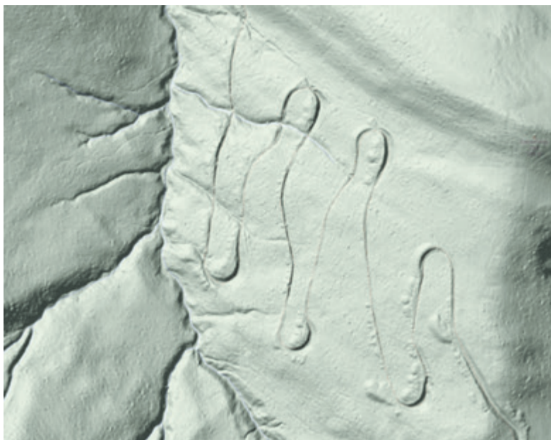
▲ Widoczne wykopy serpentyn torowiska na stoku pod Karnafłowym Łazem
